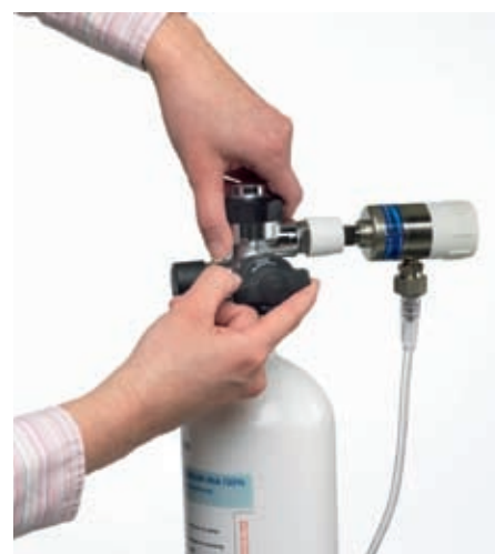
2. Öppning av flaskventilen
